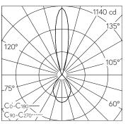
LED 4000 K 9 W 718 lm-h / CIE Flux 89 99 100 73 100 / B84 nach DIN 5040
