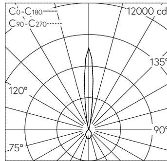
LED 3000 K 19 W 1538 lm-h / CIE Flux 88 99 100 68 100 / B84 nach DIN 5040
