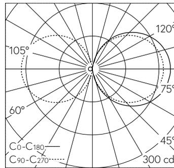
LED 4000 K 22 W 1880 lm-h / CIE Flux 13 37 66 50 100 / C11 nach DIN 5040
