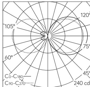
LED 3000 K 22 W 1787 lm-h / CIE Flux 13 37 66 50 100 / C11 nach DIN 5040
