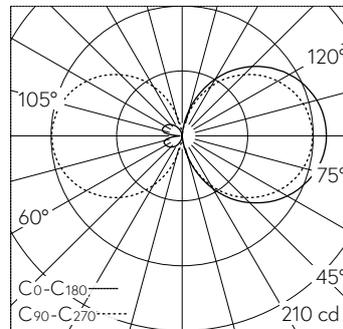
LED 4000 K 14.3 W 1246 lm-h / CIE Flux 12 37 66 50 100 / C11 nach DIN 5040
