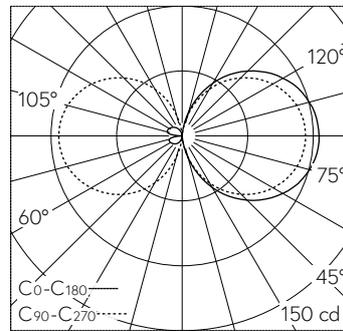
LED 4000 K 11.7 W 841 lm-h / CIE Flux 13 37 66 50 100 / C11 nach DIN 5040
