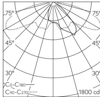
LED 4000 K 18.8 W 2408 lm-h / CIE Flux 34 68 94 100 100 / A20 nach DIN 5040
