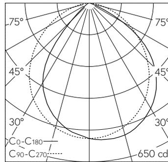
LED 4000 K 14.5 W 1323 lm-h / CIE Flux 59 89 99 100 100 / A50 nach DIN 5040
