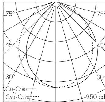
LED 4000 K 20.5 W 1767 lm-h / CIE Flux 59 89 99 100 100 / A50 nach DIN 5040
