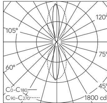
LED 3000 K 19.2 W 932 lm-h / CIE Flux 89 98 100 50 100 / C84 nach DIN 5040
