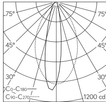
LED 3000 K 9.8 W 463 lm-h / CIE Flux 87 97 100 100 100 / A80 nach DIN 5040
