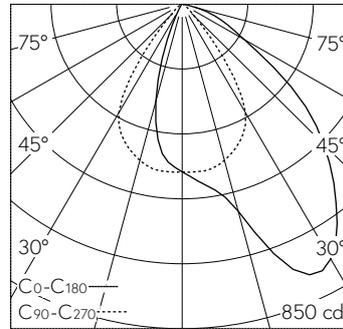
LED 3000 K 10 W 720 lm-h / CIE Flux 71 95 100 100 100 / A60 nach DIN 5040
