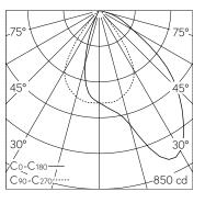
LED 3000 K 10 W 720 lm-h / CIE Flux 71 95 100 100 100 / A60 nach DIN 5040
