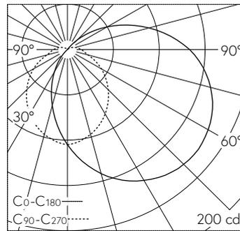
LED 3000 K 7.8 W 423 lm-h / CIE Flux 34 61 82 82 100 / B21 nach DIN 5040
