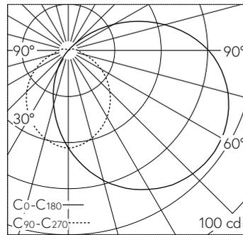
LED 4000 K 5.1 W 230 lm-h / CIE Flux 33 59 81 82 100 / B21 nach DIN 5040
