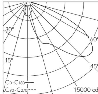
LED 3000 K 106 W 12759 lm-h / CIE Flux 38 79 98 100 100 / A30 nach DIN 5040
