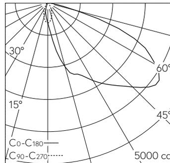
LED 3000 K 25 W 3256 lm-h / CIE Flux 36 71 97 100 100 / A30 nach DIN 5040
