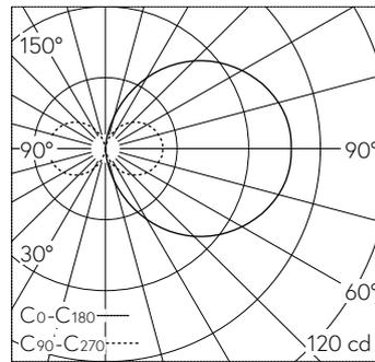
LED 4000 K 3.8 W 301 lm-h / CIE Flux 12 36 66 50 100 / C11 nach DIN 5040
