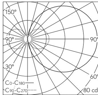
LED 3000 K 3.8 W 285 lm-h / CIE Flux 12 36 66 50 100 / C11 nach DIN 5040
