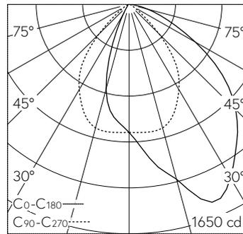
LED 3000 K 19.6 W 1750 lm-h / CIE Flux 65 92 99 100 100 / A60 nach DIN 5040
