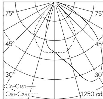
LED 3000 K 13.2 W 1178 lm-h / CIE Flux 67 93 99 100 100 / A60 nach DIN 5040
