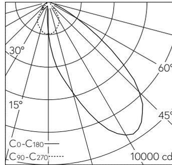
LED 4000 K 54.4 W 6406 lm-h / CIE Flux 64 95 100 100 100 / A60 nach DIN 5040
