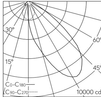
LED 3000 K 54.4 W 6209 lm-h / CIE Flux 64 95 100 100 100 / A60 nach DIN 5040
