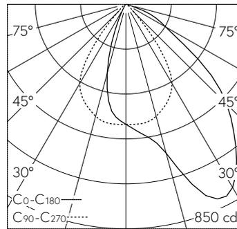
LED 4000 K 10 W 728 lm-h / CIE Flux 74 97 100 100 100 / A70 nach DIN 5040
