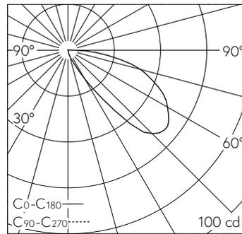
LED 4000 K 3.9 W 49 lm-h / CIE Flux 11 50 84 99 100 / A10 nach DIN 5040
