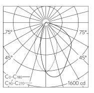
LED 4000 K 16 W 1402 lm-h / CIE Flux 61 85 97 99 100 / A50 nach DIN 5040
