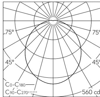
LED 3000 K 15.7 W 1356 lm-h / CIE Flux 46 75 92 97 100 / A40 nach DIN 5040
