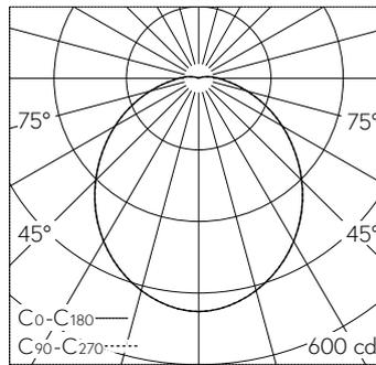
LED 4000 K 15.7 W 1425 lm-h / CIE Flux 46 75 92 97 100 / A40 nach DIN 5040
