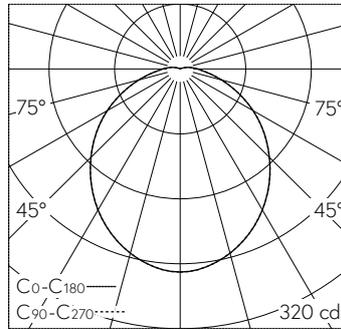
LED 3000 K 9 W 729 lm-h / CIE Flux 46 76 92 96 100 / A40 nach DIN 5040
