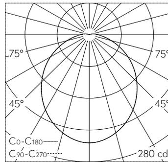
LED 3000 K 9 W 694 lm-h / CIE Flux 46 76 92 96 100 / A40 nach DIN 5040
