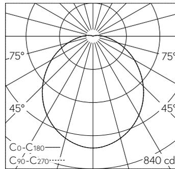
LED 3000 K 27.2 W 2131 lm-h / CIE Flux 45 75 91 96 100 / A40 nach DIN 5040
