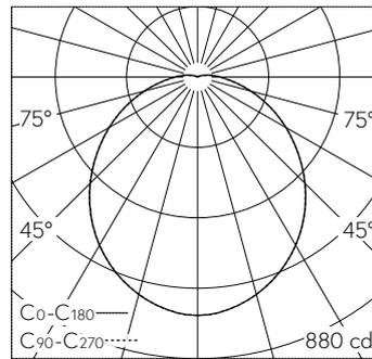
LED 4000 K 27.2 W 2241 lm-h / CIE Flux 45 75 91 96 100 / A40 nach DIN 5040
