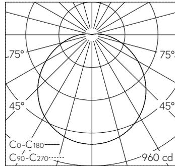
LED 3000 K 26.5 W 2651 lm-h / CIE Flux 43 73 90 96 100 / A30 nach DIN 5040
