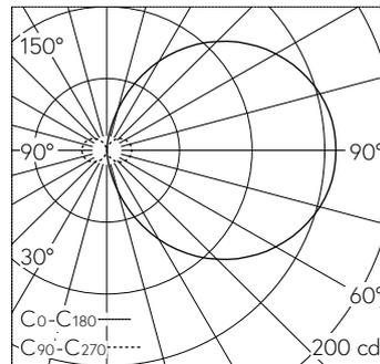
LED 3000 K 6.6 W 550 lm-h / CIE Flux 13 37 66 50 100 / C11 nach DIN 5040
