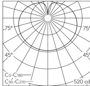
LED 3000 K 17,6 W 2547 lm-h / CIE Flux 26 52 76 58 100 / C22 nach DIN 5040
