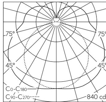
LED 4000 K 27 W 3929 lm-h / CIE Flux 36 65 86 73 100 / B31 nach DIN 5040
