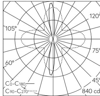
LED 3000 K 23 W 816 lm-h / CIE Flux 47 61 78 50 100 / C32 nach DIN 5040
