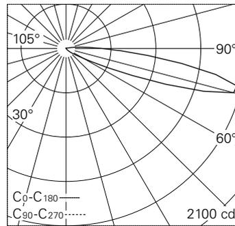
LED 3000 K 15 W 848 lm-h / CIE Flux 0 4 38 92 100 / A11 nach DIN 5040
