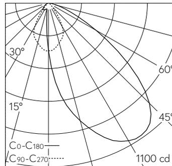
LED 4000 K 9.5 W 828 lm-h / CIE Flux 64 93 99 100 100 / A60 nach DIN 5040
