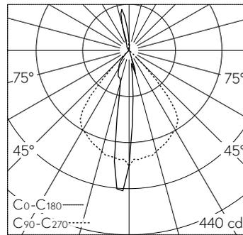
LED 4000 K 6.7 W 156 lm-h / CIE Flux 91 100 100 97 100 / A84 nach DIN 5040
