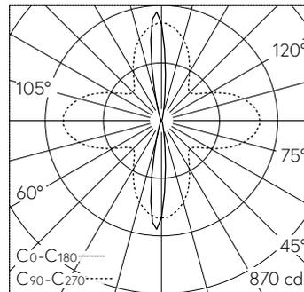
LED 3000 K 23 W 763 lm-h / CIE Flux 47 61 79 50 100 / C32 nach DIN 5040
