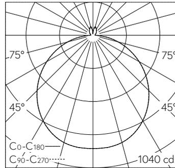
LED 3000 K 30.8 W 2895 lm-h / CIE Flux 46 77 94 93 100 / A43 nach DIN 5040
