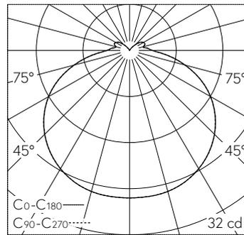
LED 3000 K 1.6 W 95 lm-h / CIE Flux 39 69 89 89 100 / B31 nach DIN 5040
