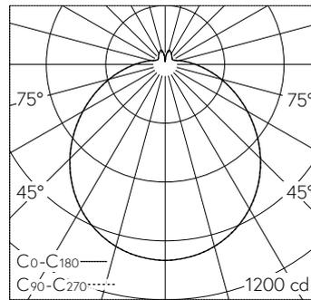
LED 4000 K 30.8 W 3651 lm-h / CIE Flux 42 71 89 88 100 / B31 nach DIN 5040
