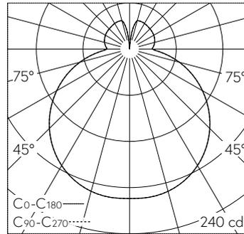
LED 3000 K 9 W 725 lm-h / CIE Flux 40 70 89 76 100 / B32 nach DIN 5040
