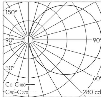
LED 4000 K 6.7 W 630 lm-h / CIE Flux 13 37 66 50 100 / C11 nach DIN 5040
