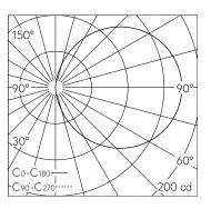
LED 4000 K 4.9 W 485 lm-h / CIE Flux 13 37 66 50 100 / C11 nach DIN 5040
