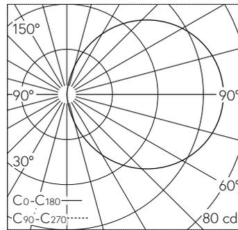
LED 4000 K 2.9 W 157 lm-h / CIE Flux 13 37 66 50 100 / C11 nach DIN 5040
