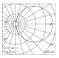
LED 3000 K 14 W 1148 lm-h / CIE Flux 13 37 66 50 100 / C11 nach DIN 5040
