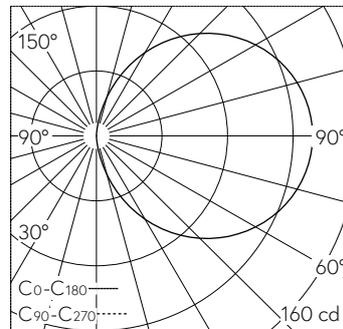
LED 4000 K 9.7 W 922 lm-h / CIE Flux 13 37 66 50 100 / C11 nach DIN 5040
